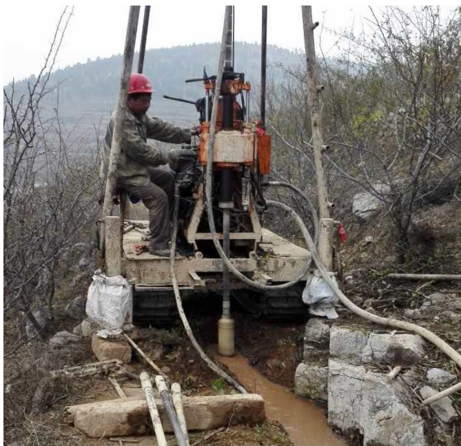
“低压力，中转速”钻机钻进图
